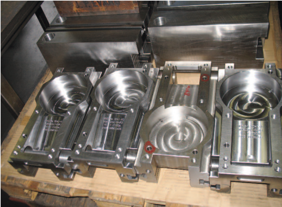
Logement du système hydraulique d'un étaux.
